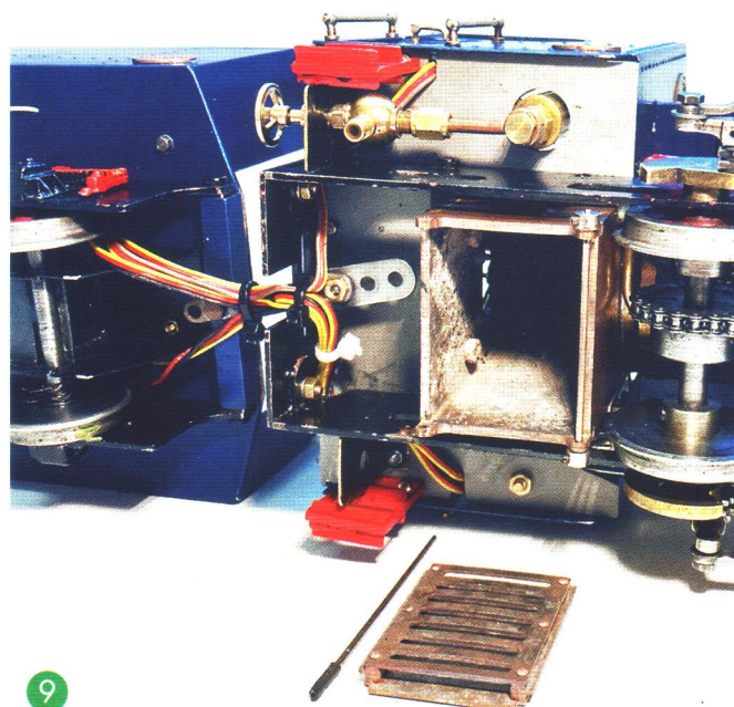
Feuerraum von unten, Feuerrost und dessen Halterungsstangen, Ölerablassventil, Stufenhalterungen und Kabelführung
