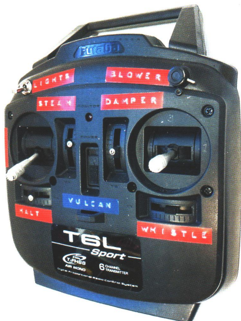
Oben rechts der Hilfsbläserregler mit Begrenzer. Rechter Joystick regelt mit vorwärts/rückwärts sowohl Pfeife als auch Feuertür. Linker Joystick regelt Dampfzufuhr mit vorwärts/rückwärts und Steuerung mit li/re.
