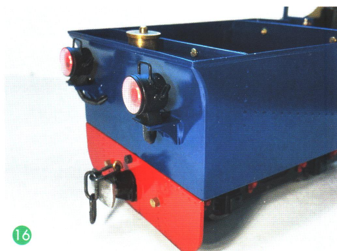
16 Rückleuchten am Tender, farbige LED-Kabel in Schrumpfschläuchen versteckt
