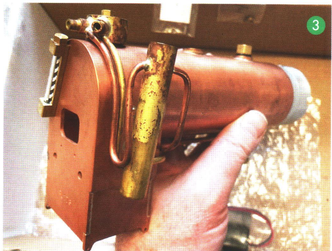
Neuer, gerade ausgepackter Riverdale-Kessel, mit der tiefen Feuerbüchse. Kupfer-Dampfleitung und Messing-Hilfsbläser-Leitung laufen nebeneinander unterhalb des Kessels
