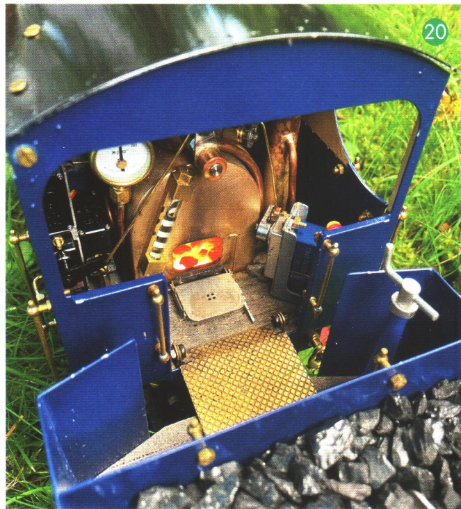
40 psi auf dem Manometer, ein gesundes Feuer, genug Wasser, es kann losgehen!
